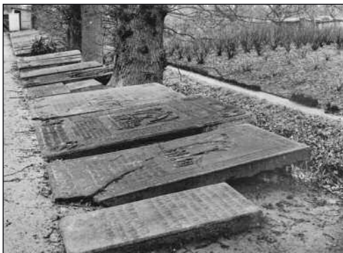
In Horizontallage lagerten die alten Grabplatten bis in die 1950er-Jahre schon viele Jahrzehnte; teilweise gebrochen, da sie nicht vollständig unterstützt waren!
