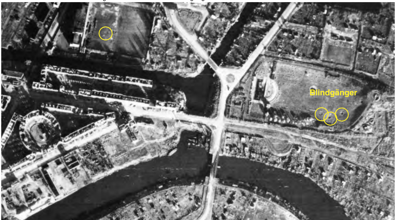
Die Aufnahme vom 10.11.1945 zeigt Bombenschäden und Blindgängerlöcher an der Süderstraße in Höhe Braune Brücke
